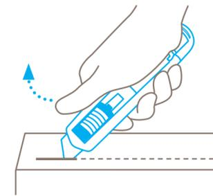
Nehmen Sie den **Daumen vom Schieber**, damit der automatische Klinsenrückzug funktioniert.
