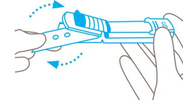
Klinge entnehmen und wenden oder wechseln. Achten Sie darauf, die Klinge wieder **genau auf die Nocken** zu legen. Linkshänder drehen die Klinge um 180°.
