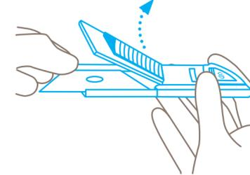
Klinge an der **stumpfen** Seite anfassen und mit ihrer Hilfe die Klinsenabdeckung nach oben hebeln. Die Abdeckung verbleibt in der geöffneten Stellung.
