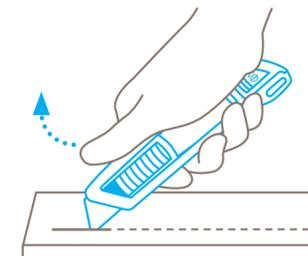
Nehmen Sie den **Daumen vom Schieber**, damit der automatische Klinsenrückzug funktioniert.
