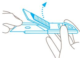
Klinge an der **stumpfen** Seite anfassen und mit ihrer Hilfe die Klinsenabdeckung nach oben hebeln. Die Abdeckung verbleibt in der geöffneten Stellung.
