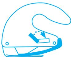
Bügel **anheben** und nach unten drehen, bis sein Ende auf dem Klingenwechselknopf aufliegt.
