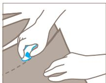
**Verwendung:** Zum Schneiden von Papier, Folie und Schaumstoff. **Handhabung:** Daumen vom Schieber nehmen und mit einer schiebenden Bewegung schneiden. **Klingenwechsel:** Klingenschwächer nach oben pressen und die Klinge aus dem Klingenschlitz drücken. **ACHTUNG:** Material nur bedingt abriebfest.
