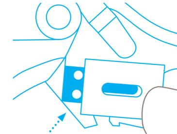
Danach die Klinge links **an der Kante ausrichten** und **exakt** auf den Nocken zurücklegen.
