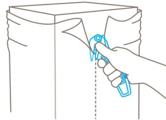
Mit der Messernase **gelangen** Sie ins Schneidmaterial. Sie können sie auch als Führung beim Schneiden nutzen.
