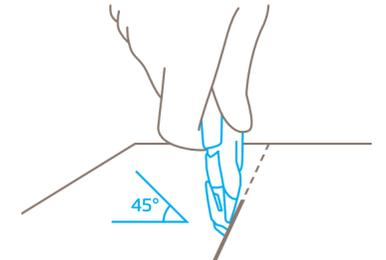
Zum Schneiden von Kartons halten Sie das Schneidwerkzeug **am besten schräg**.
