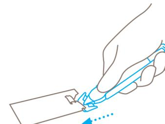
Verwenden Sie den außen liegenden Schabebereich für **leichte Schabarbeiten**, z. B. zum Entfernen von Etiketten.
