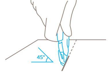
Zum Schneiden von Kartons halten Sie das Schneidwerkzeug **am besten schräg**.
