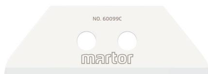
Die KERAMIKKLINGE NR. 60099C ist eine besonders hochwertige Klinge aus Keramik. Sie ist dauerhaft sehr scharf und verfügt über zwei nacheinander nutzbare Schneidkanten für eine noch längere Einsatzzeit. Der Breitschliff erleichtert das Schneiden, die abgerundeten Spitzen erhöhen Ihre Sicherheit. Die Klinge ist 55,5 mm lang, 19 mm breit und 0,65 mm stark.
