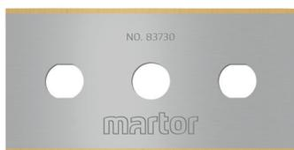
Die INDUSTRIEKLINGE NR. 83730 von MARTOR ist eine hochwertige Klinge aus rostfreiem Stahl inkl. TiN-Beschichtung. Sie ist sehr scharf und verfügt über vier nacheinander nutzbare Schneidkanten für eine besonders hohe Einsatzzeit. Die Klinge ist 43 mm lang, 22 mm breit und 0,30 mm stark. Das für die Klinge verwendete Öl ist lebensmittelecht.
