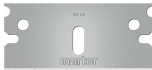
Die INDUSTRIEKLINGE NR. 65 von MARTOR ist eine hochwertige Klinge aus Stahl. Sie ist sehr scharf und verfügt über eine nutzbare Schneide. Die Klinge ist 39 mm lang, 18,7 mm breit und 0,30 mm stark.
