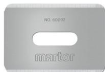
Die INDUSTRIEKLINGE NR. 60092 von MARTOR ist eine hochwertige Klinge aus Stahl. Sie ist sehr scharf und verfügt über vier nacheinander nutzbare Schneidkanten für eine besonders hohe Einsatzzeit. Die abgerundeten Spitzen erhöhen Ihre Sicherheit. Die Klinge ist 26 mm lang, 18,5 mm breit und 0,40 mm stark.
