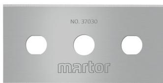
Die INDUSTRIEKLINGE NR. 37030 von MARTOR ist eine hochwertige Klinge aus Stahl. Sie ist sehr scharf und verfügt über vier nacheinander nutzbare Schneidkanten für eine besonders hohe Einsatzzeit. Die Klinge ist 43 mm lang, 22 mm breit und 0,30 mm stark.
