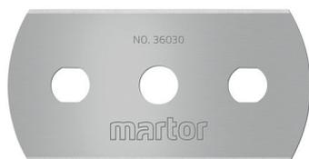
Die INDUSTRIEKLINGE NR. 36030 von MARTOR ist eine hochwertige Klinge aus Stahl. Sie ist sehr scharf und verfügt über vier nacheinander nutzbare Schneidkanten für eine besonders hohe Einsatzzeit. Die Klinge ist 43,2 mm lang, 22 mm breit und 0,30 mm stark.
