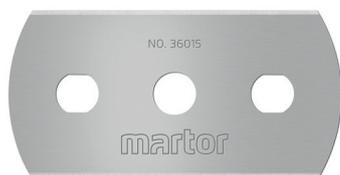
Die INDUSTRIEKLINGE NR. 36015 von MARTOR ist eine hochwertige Klinge aus Stahl. Sie ist sehr scharf und verfügt über vier nacheinander nutzbare Schneidkanten für eine besonders hohe Einsatzzeit. Die Klinge ist 43,4 mm lang, 22 mm breit und 0,15 mm stark.
