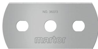
Die INDUSTRIEKLINGE NR. 36013 von MARTOR ist eine hochwertige Klinge aus Stahl. Sie ist sehr scharf und verfügt über vier nacheinander nutzbare Schneidkanten für eine besonders hohe Einsatzzeit. Die Klinge ist 43,4 mm lang, 22 mm breit und 0,13 mm stark.
