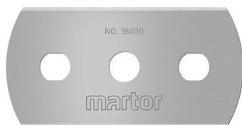
Die INDUSTRIEKLINGE NR. 36010 von MARTOR ist eine hochwertige Klinge aus Stahl. Sie ist sehr scharf und verfügt über vier nacheinander nutzbare Schneidkanten für eine besonders hohe Einsatzzeit. Die Klinge ist 43,4 mm lang, 22 mm breit und 0,10 mm stark.
