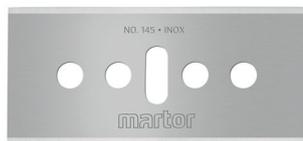
Die INDUSTRIEKLINGE NR. 145 von MARTOR ist eine hochwertige Klinge aus rostfreiem Stahl. Sie ist sehr scharf und verfügt über vier nacheinander nutzbare Schneidkanten für eine besonders lange Einsatzzeit. Die Klinge ist 39,0 mm lang, 18,4 mm breit und 0,30 mm stark. Das für die Klinge verwendete Öl ist lebensmittelecht.
