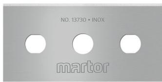
Die INDUSTRIEKLINGE NR. 13730 von MARTOR ist eine hochwertige Klinge aus rostfreiem Stahl. Sie ist sehr scharf und verfügt über vier nacheinander nutzbare Schneidkanten für eine besonders hohe Einsatzzeit. Die Klinge ist 43 mm lang, 22 mm breit und 0,30 mm stark. Das für die Klinge verwendete Öl ist lebensmittelecht.
