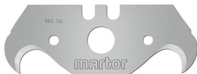
Die HAKENKLINGE NR. 56 von MARTOR ist eine hochwertige Klinge aus Stahl. Sie ist sehr scharf und verfügt über zwei nacheinander nutzbare Schneidkanten für eine höhere Einsatzzeit. Die Klinge ist 51 mm l ang, 19 mm br eit und 0,63 mm stark.
